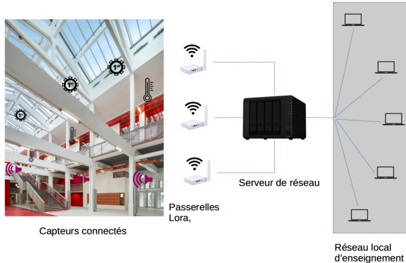
Fig.1 : L'architecture du réseau de capteurs multi-physiques qui seront déployés sur le bâtiment IUT Pajol
